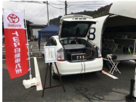
ハイブリッド車から運行基地局への給電
